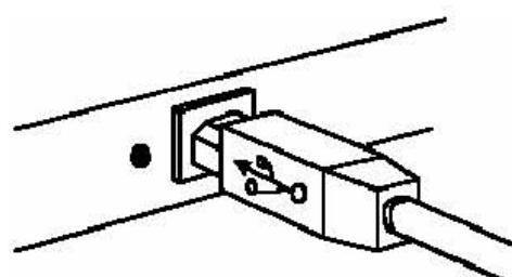
Рисунок 3.1.4. Подключение USB-кабелем.
