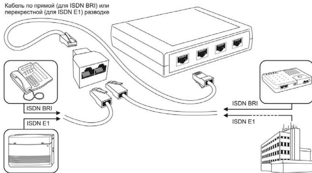
Рисунок 3.2.1. Подключение линии ISDN к порту адаптера.
