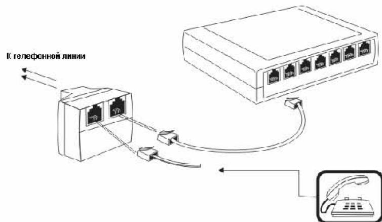
Рисунок 3.1.3 Использование телефонного разветвителя.
